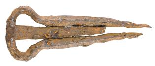
较特殊的形态。金相分析结果显示,利用扫描电镜能谱仪进行分析,除铁锈外,还有黄铜的成分,以及 少量硫化物。在三岔处其金相组织为铁素体和珠光体组织,含碳量约0.4%,在本视场内未发现两块 钢才锻接痕迹和其他类型的夹杂物。"是目前已知的唯一一件金属自体口弦。
